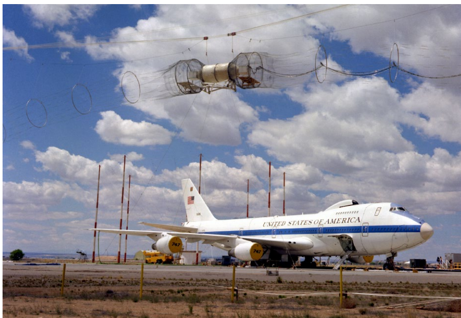
Kirtland Airforcebase, New Mexico USA, 1979. EMP-beproeving van Advanced Airborn Command Post Boeing E4 USAF. De EMP-simulator is van een zelfde type als de EMP-beproeving van het nieuwbouw statisch Verbindingscentrum in Vught in 1984. (foto sgt Ernie Stone, USAF)
